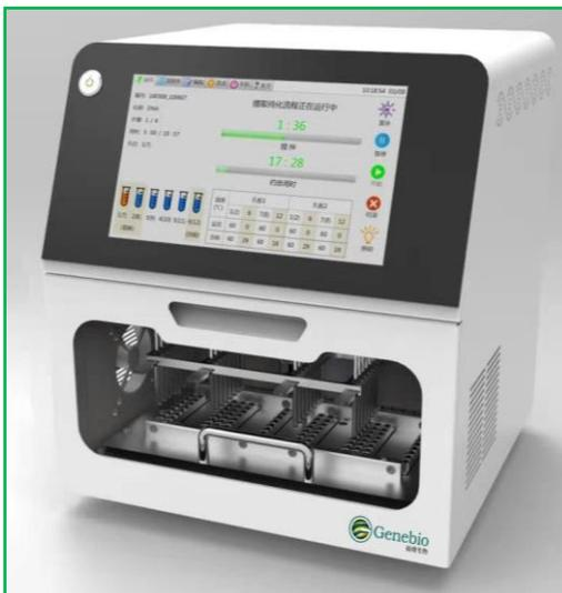
Предназначена для автоматизированного выделения ДНК (до 32 проб за запуск) из широкого спектра криминалистических образцов при ДНК идентификации и установлении родства. Предварительно установлены протоколы для нескольких наборов реагентов, включая **SF Mag FCS DNA Kit**. Кроме того пользователь может создавать и редактировать свои протоколы для различных ручных наборов реагентов для выделения ДНК.
